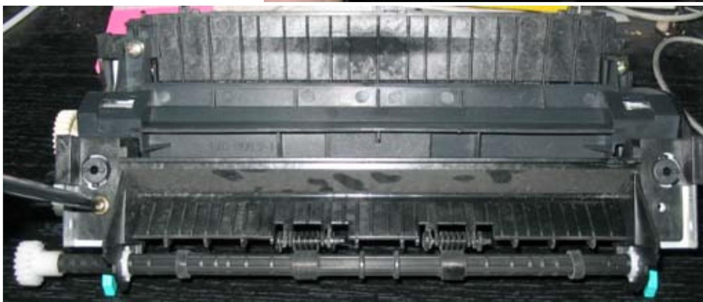
И вот печка у нас в руках. Положим ее на стол и приступим к разборке. Для начала выкрутим пару винтов ( на картинке сверху процесс показан ) и снимем черную пластмассовую крышку с выходным валом тракта подачи бумаги.
