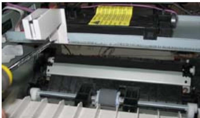
Теперь мы можем отогнуть все 4 защелки и снять верхнюю крышку ( с желтой предупреждающей наклейкой ), чтобы получить доступ к оптике блока лазера.
