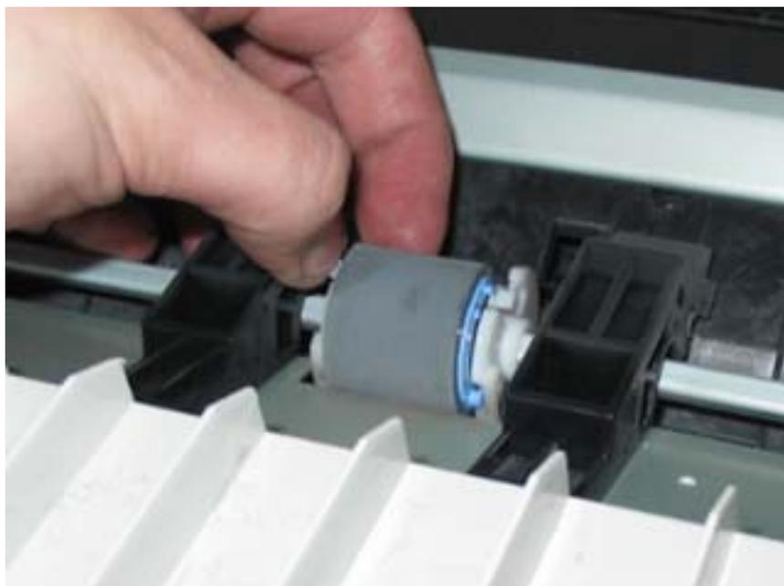
Теперь обратим внимание на вал, на котором держится этот ролик-эксцентрик. С обоих концов на этот вал надеты белые пластмассовые детали с выступающими кулачками, которые обеспечивают прижим бумаги к ролику-эксцентрику. Места контакта этих деталей с боковыми деталями корпуса необходимо хорошо смазывать, иначе принтер начинает издавать негромкое потрескивание и иногда не может захватить бумагу.
