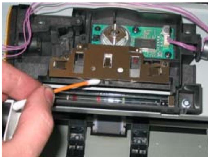
Если есть необходимость сделать профилактику двигателю, вращающему квадратное зеркало, то для снятия маховика надо вытащить черный Г-образный держатель ( после поворота на 90 градусов он вынимается на себя ). После снятия маховика с зеркалом все трущиеся поверхности тщательно протираются от грязи ( салфетки + спирт или ацетон ), после чего наносится смазка. Если нет веретенного
