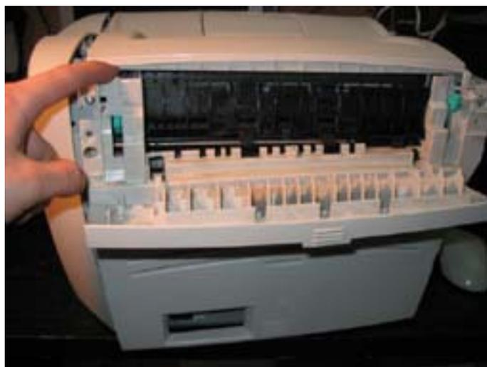
Теперь сдвинем немного в сторону верхнюю часть правой боковой крышки принтера (сейчас она для нас слева) и потянем заднюю крышку принтера на себя. Движению будут мешать зеленые рычажки, их можно сдвинуть в среднее положение. Задняя крышка снимется на нас.
