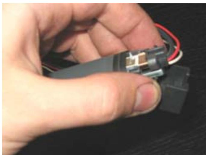
проводов ). При этом приходится приложить некоторое усилие. После того, как крышечка снята, можно снимать термопленку. При этом провода остаются внутри термопленки, что немного усложняет процесс.
