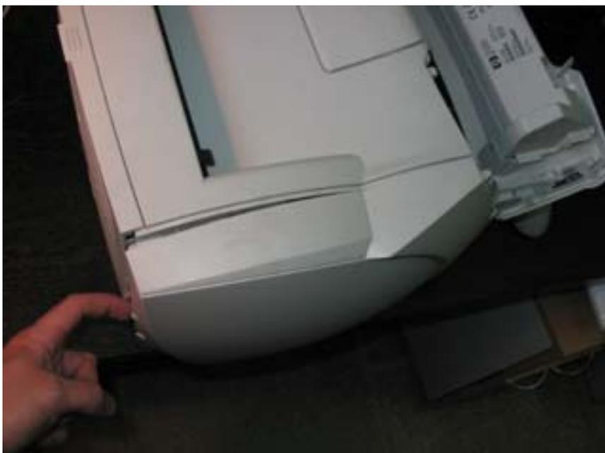
Под этой крышкой находится форматор (интерфейсная плата) принтера с разъемами (LPT и USB) и гнездом для дополнительной памяти.
