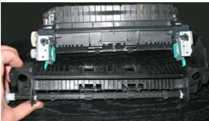
Эти пробки – самое интересное отличие принтеров этой серии от аналогов. Хорошо запомните их рабочее положение – фиксатор ( немного выступающая вверх часть пробки ) находится в нижнем ( на картинке левая пробка ) и в верхнем ( на картинке правая пробка ) пазах.
