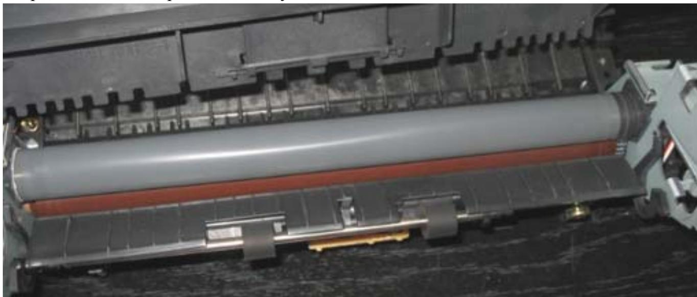
Теперь нам прекрасно видна серая термопленка ( или то, что от нее осталось ), внутри нее – нагревательный элемент, а под ней – рыжий резиновый вал с тефлоновым покрытием, придавливающий бумагу к нагревательному элементу через термопленку.
