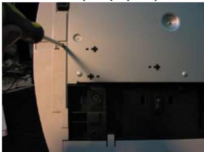
Остается снять верхнюю крышку принтера. Для этого откручиваются 2 винта в передней части правой и левой сторон верхней крышки (винтов там больше, но надо открутить только те, которые держат верхнюю крышку; узнать их можно покачивая крышку при частично выкрученном винте – если крышка начинает двигаться, то винт откручивается совсем, если нет, то закручивается обратно). Под верхней крышкой находится верхняя часть принтера с блоком лазера (его легко узнать по желтой предостерегающей наклейке).
