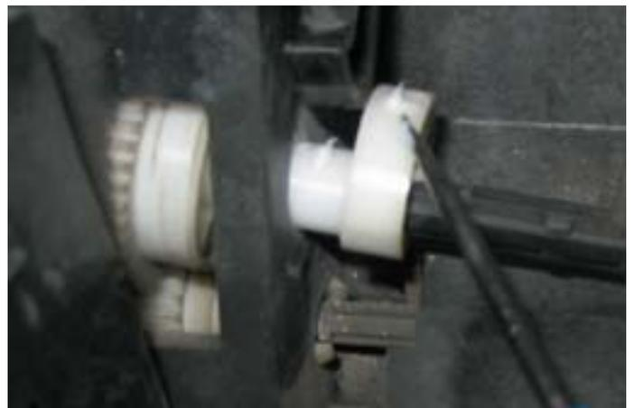
Сборка производится в обратном порядке. Перед установкой на свое место белого кулачка надо нанести немного силиконовой смазки как на сам кулачек, так и на ту часть, которая утопится в отверстие. Конечно, механизм подталкивания бумаги должен находиться во вдавленном внутрь состоянии.
