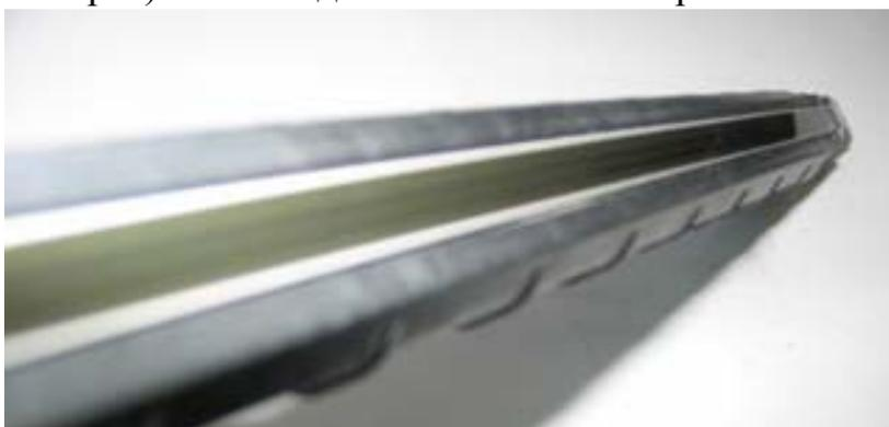
После того, как вся старая смазка полностью удалена, можно оценить состояние нагревательной пластины. В идеале на ней не должно быть поперечных царапин (обычно появляются на концах пластины из-за попадания тонера и твердой пыли). Если царапины заметны – нагревательную пластину желательно поменять, иначе это приведет к быстрому износу внутренней поверхности термопленки и частым остановкам при печати.
