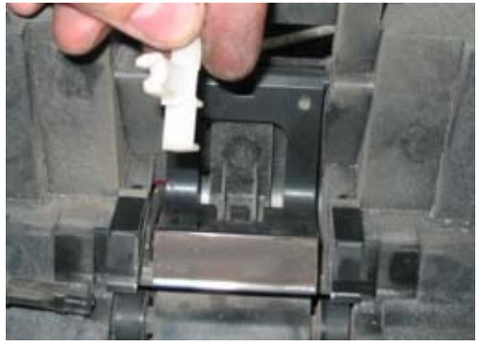
Остается снять белый держатель тормозной площадки движением вверх. После этого снимается сама тормозная площадка (оси выходят назад). Теперь эту площадку можно заменить или восстановить. Если есть выравнивающие площадки – можно поставить новые, защелки находятся внутри принтера и доступны при определенных навыках.
