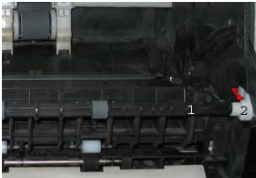
Вал смещается вправо, при этом левый его конец выходит из шестеренки механизма. Теперь вал можно немного наклонить на себя и вытащить влево. Резиновые части этого вала желательно промыть бензином или жидкостью FormulaA. Место соединения деталей 1 и 2 требует силиконовой смазки.
