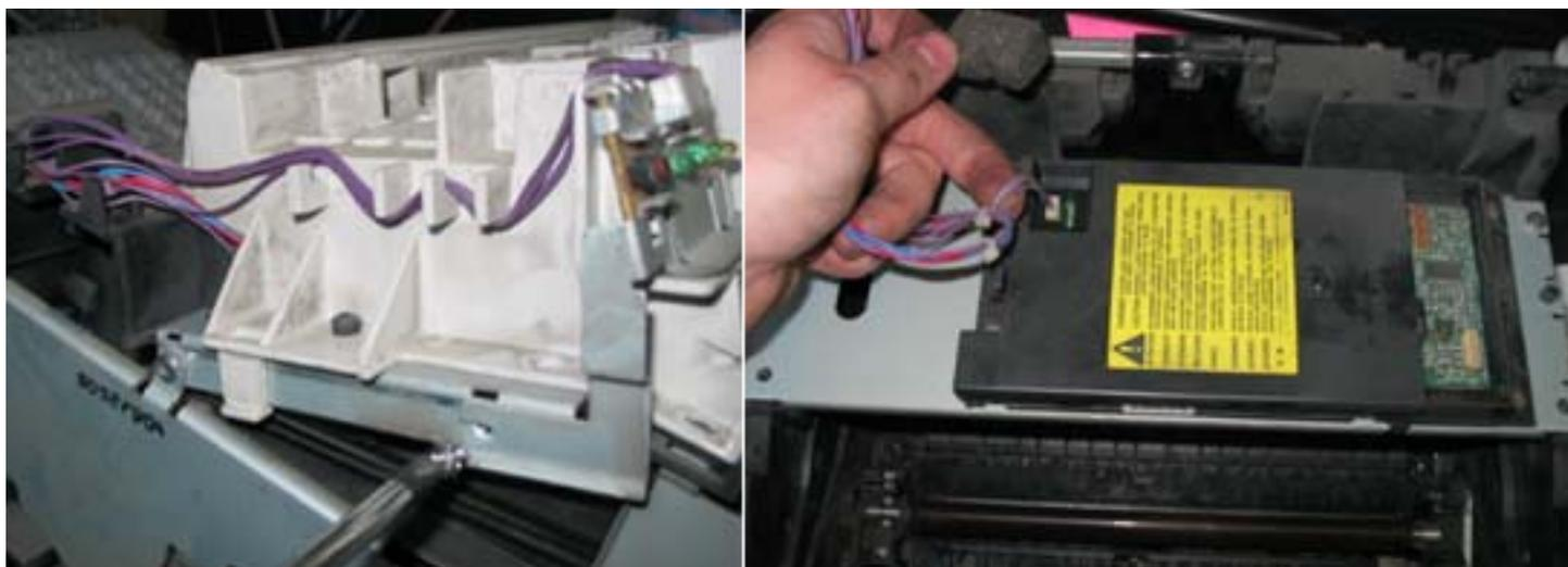
После того, как винты и саморезы будут выкручены, отгибаются 2 защелки и пластмассовая часть поднимается вверх. При этом открывается вид на блок лазера.
