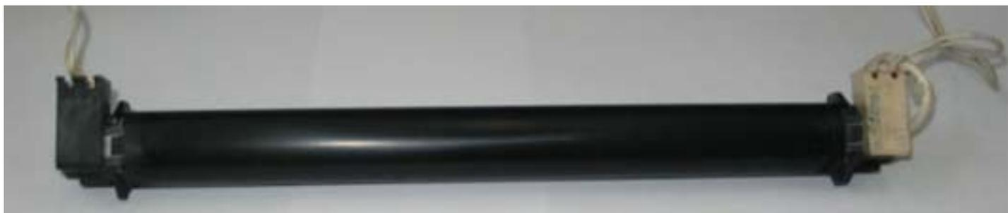
Слева видна черная деталь с отходящими от нее двумя тонкими белыми ( когда-то ) проводами – это токосъемник термодатчика. Для того, чтобы его снять ( а это необходимо для продолжения работы ) надо отогнуть защелку и потянуть токосъемник. На картинке видны контакты токосъемника (внутри).
