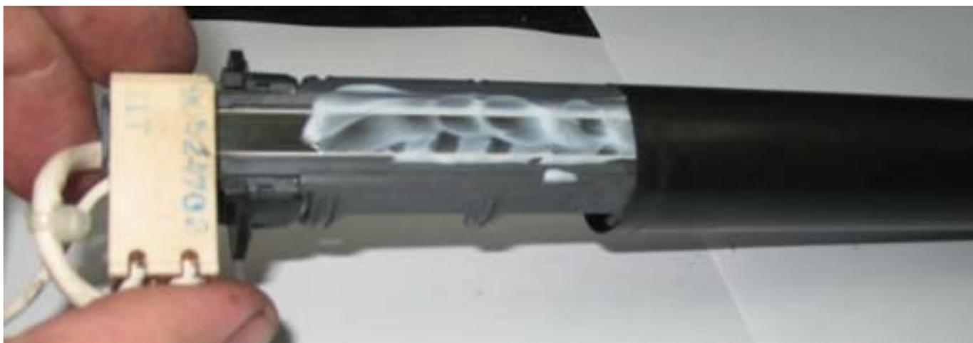
После того, как термопленка возвращена на свое место, ставятся на место снятые ранее детали (черную деталь, удерживающую термопленку на месте и токосъемник термодатчика). При этом желательно очистить эту черную деталь от старой смазки, а контакты нагревательной пластины от грязи, смазки и окисла (стирательной резинкой). Не перестарайтесь – металл напылен тонким слоем и лучше оставить все как есть, чем испортить контакты и выкинуть нагреватель.
