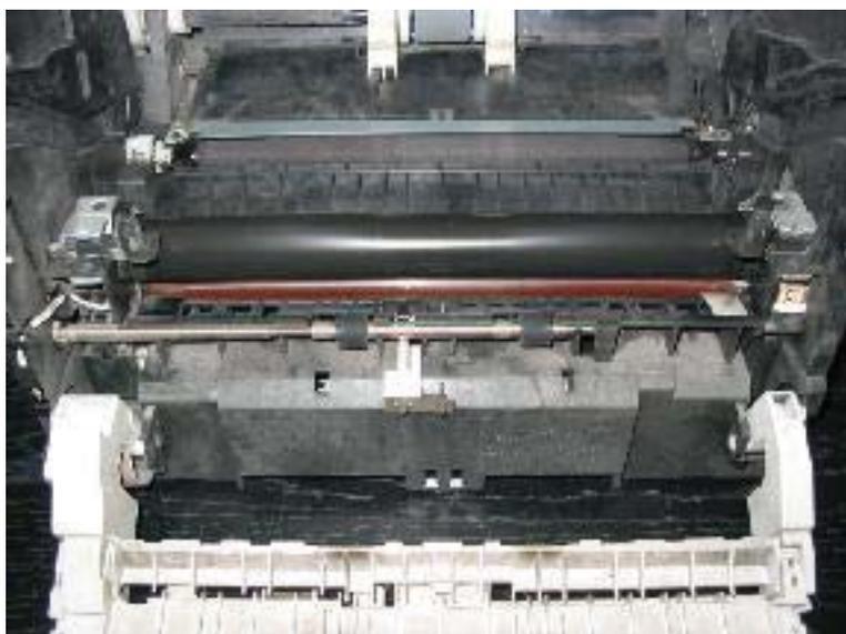
Пора снимать прижимы, придавливающие нагревательный узел (нагревательный элемент с термопленкой) к резиновому валу (который под ним). Для этого выступающая вверх часть прижима вдавливается вниз и сдвигается внутрь принтера (направление показано красной стрелкой на рисунке справа).
